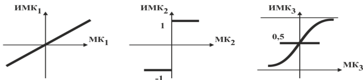
Рис. 3.4. Функции трансфера нейронов: а) линейная; в) ступенчатая; с) сигмоидальная
